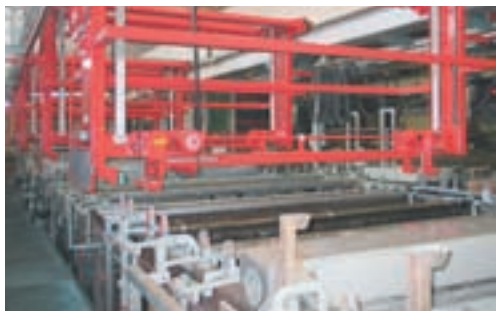
Eine der galvanischen Beschichtungslinien bei der Firma Friedrich Grohe in Lahr
