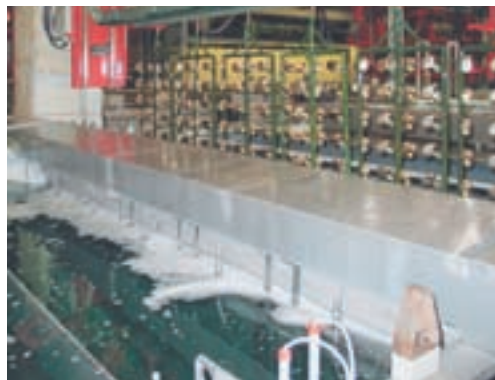
Spülbecken mit beiderseitiger Beschallung in optimaler Leistungsausführung
